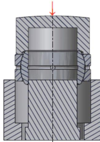
Gleichzeitige Montage von Welle und Lager
